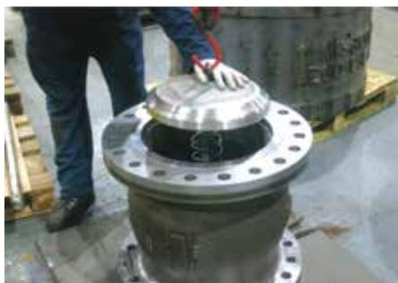
图2：轴流式止回阀的弹簧助力轻质阀瓣
