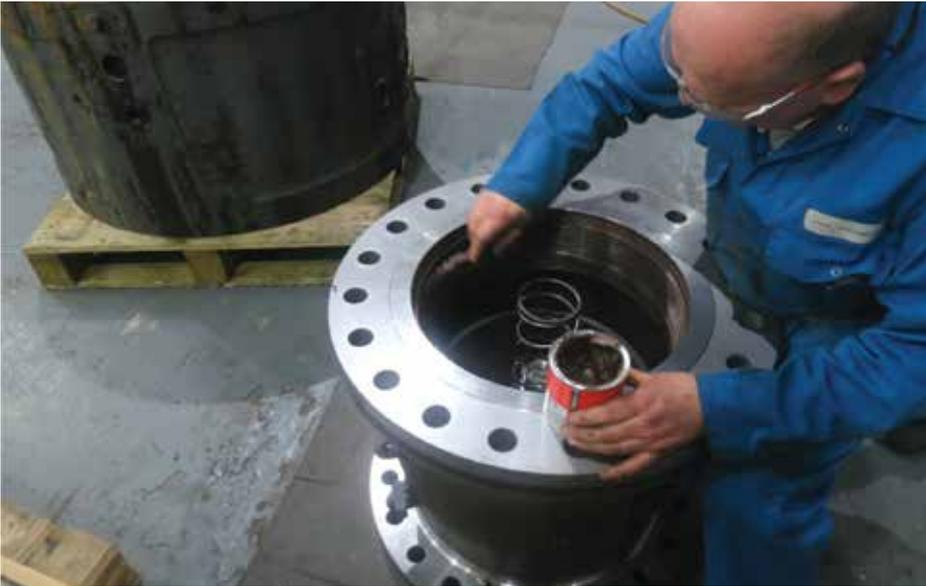
图6: 送回Crane做保养的阀门正在接受阀座涂油处理
