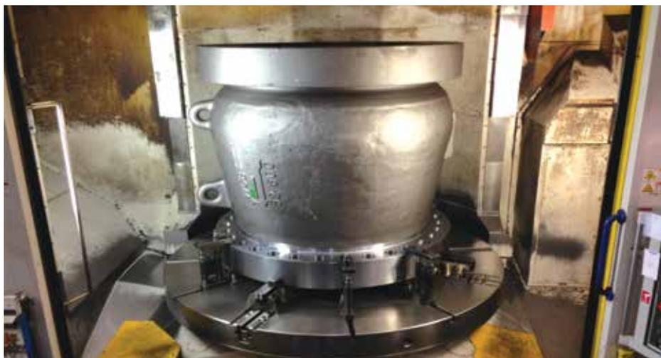
图4: 整体式阀体缓冲止回阀，无螺栓连接的阀盖
