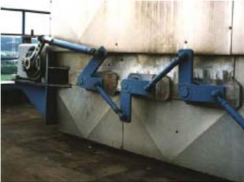
图34 采用角行程执行机构及多重盖片进行废气控制
