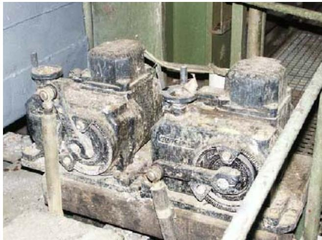
图9 Contrac执行机构在最为恶劣的条件下可靠地运行
